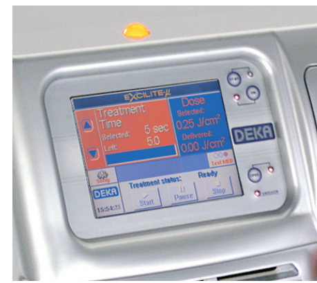
Il touch screen a colori assicura grande semplicità di utilizzo: dopo il test per determinare la MED (Minimum Erythema Dose) è sufficiente impostare il tempo di emissione in base ai protocolli di trattamento DEKA.
